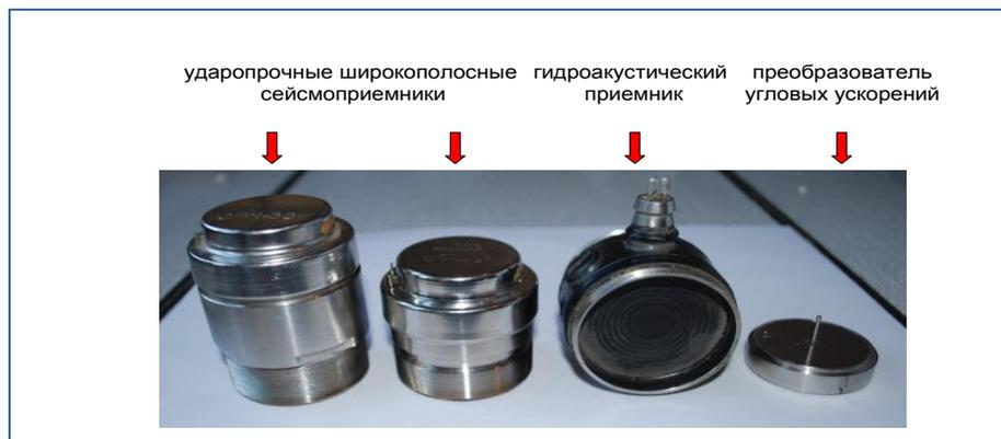
Рис. 7. Измерители механических величин, изготовленных на основе электрокинетического преобразователя с металлическим корпусом, и выпущенные опытным и мелкосерийным производством НПО «Квант».
