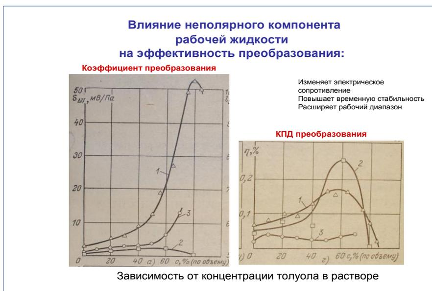
Рис. 4. Влияние толщины двойного электрического слоя и содержания неполярного компонента в рабочей жидкости на эффективность электрокинетического преобразования.
