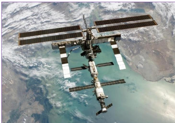
Рис. 2. МКС, на которой установлены и успешно работают кремниевые СБ с двусторонней чувствительностью производства АО «НПП «Квант».
