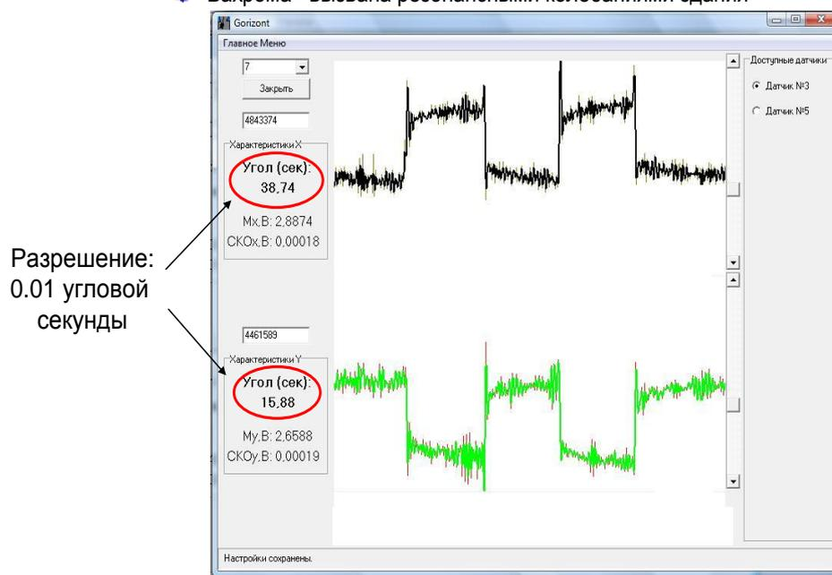
Рис. 12. Пример записи выходных сигналов, характеризующих углы наклона ИН-Д3 по измерительным осям X и Y.
