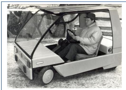
Рис. 1. Электромобиль на базе автомобиля УАЗ: грузоподъемность 800 кг, максимальная скорость 70 км/ч.
