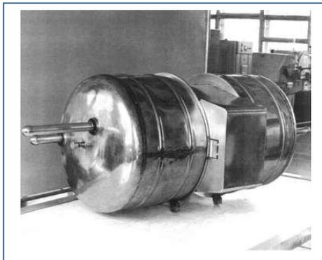
Термоэлектрический генератор с реакторный нагревом.
