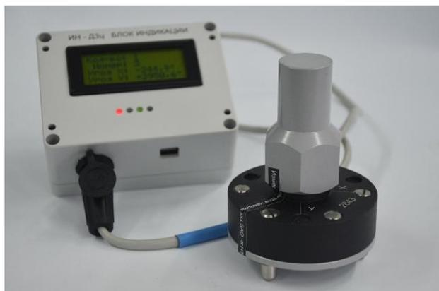
Рис. 11. Внешний вид измерителя угла наклона ИН-Д3 с блоком индикации.
