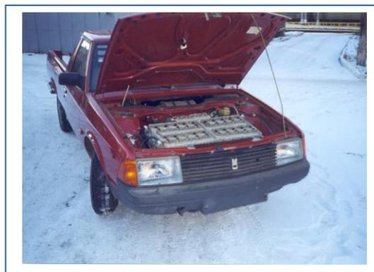
Рис. 4. Электромобиль на базе автомобиля «Москвич»: грузоподъемность 500 кг.
