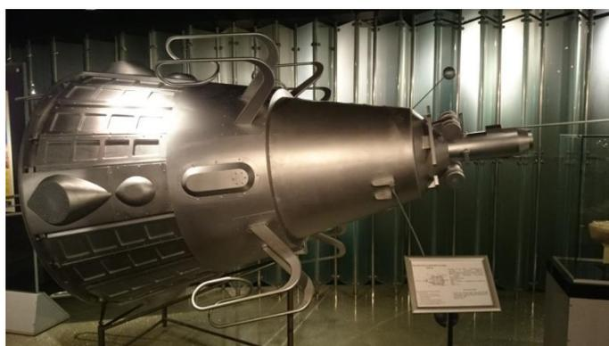
Рис. 1. Советский искусственный спутник Земли «Спутник-3» с первой кремниевой солнечной батареей мощностью несколько десятков ватт. Выведен на орбиту 15 мая 1958 года.
